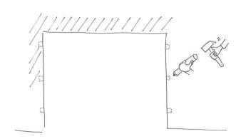
3. Meißeln Sie an der gezeichnete Stelle die Löcher für die Ankerplatten aus und bohren Sie Löcher für Dübel vor.
