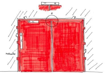
7. Richten Sie beide Türflügel mit Hilfe einer Wasserwage und einem Keil aus. Erst danach können alle Ankerplatten mit Dübeln und Schrauben befestigt werden.
