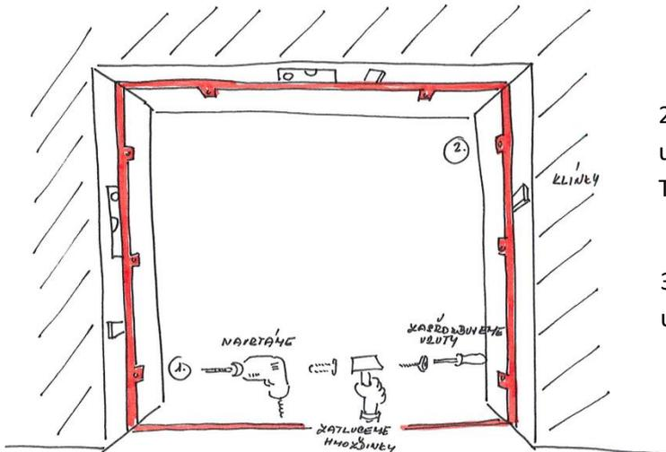
2. Die Löcher für Schrauben am Punkt 1 und 2 (diagonal) bohren und den Türrahmen anschrauben.
