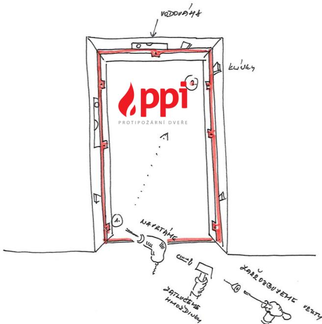
2. Bohren Sie 2 Löcher für Schrauben am Punkt 1 und 2 (diagonal) und schrauben Sie den Türrahmen an.
