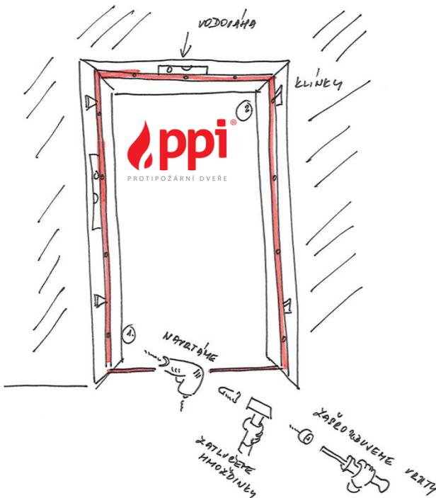
2. Mit Hilfe einer Wasserwaage und Keile richten Sie den Türrahmen in der Bauöffnung ein.
