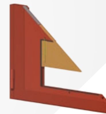
2. v případě požáru šňůra uvolní klapku
