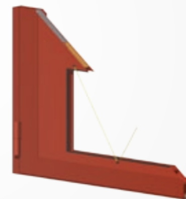
1. šňůra drží ventilační klapku v poloze otevřeno
